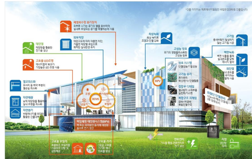
[그림 36] 제로에너지건축물 적용 기술 예시 출처 : 제로에너지빌딩
