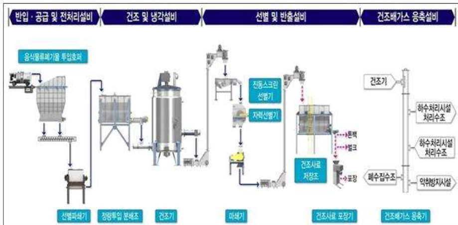
[그림 10] 하남소각장 음식물자원화시설 처리 계통도
